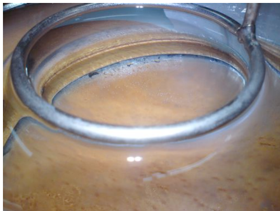
Superficie de agua abombada por la fuerza ejercida por el aro
